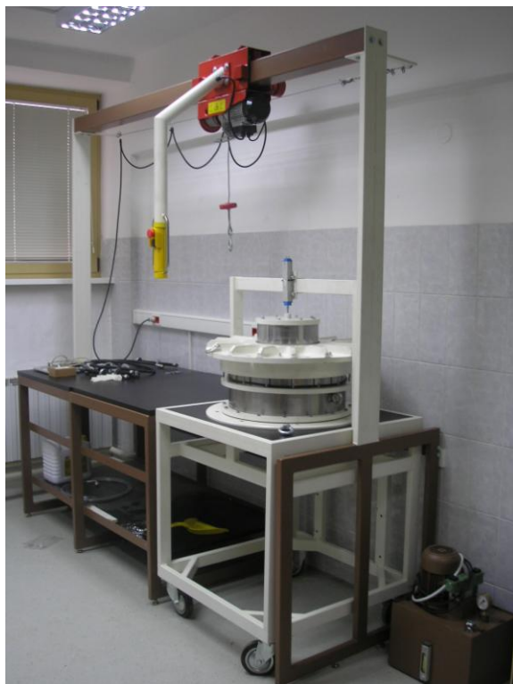
Slika 1. Veliki edometar u laboratoriju Geotehničkog fakulteta
